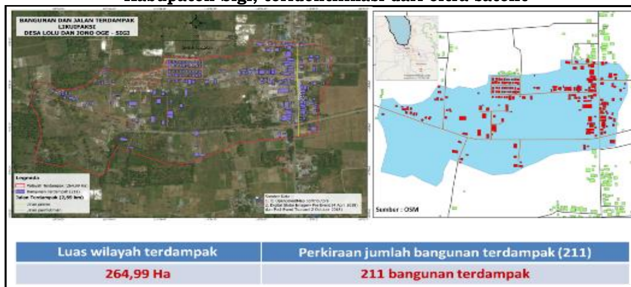
Gambar II.8 Cakupan wilayah terdampak likuifaksi di wilayah Lolu di Kabupaten Sigi, teridentifikasi dari citra satelit
